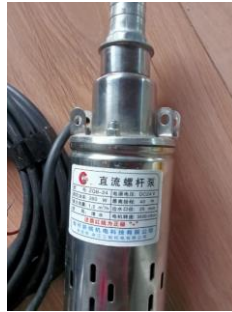
Gambar 4.1. Pompa air submersible dc.
