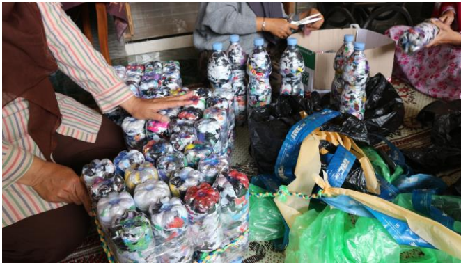
Gambar 11. Kegiatan memotong sampah plastik, memadatkannya di dalam botol, dan terbentuk ecobrick
