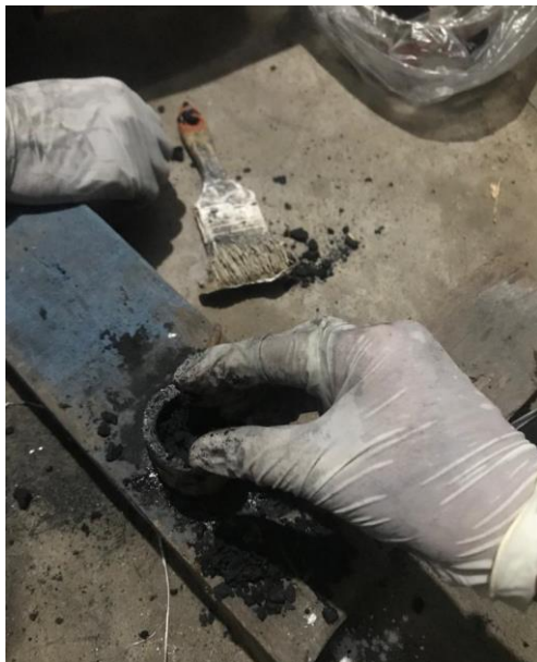
Gambar 1. 2 Proses pembuatan briket limbah tongkol jagung
