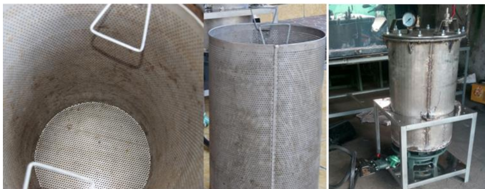
Gambar 6. Inner tube , Tabung presto hasil kegiatan
