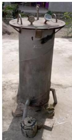
Gambar 2a. Autoclave sebelum PkM (Belum Memenuhi Stadar )
