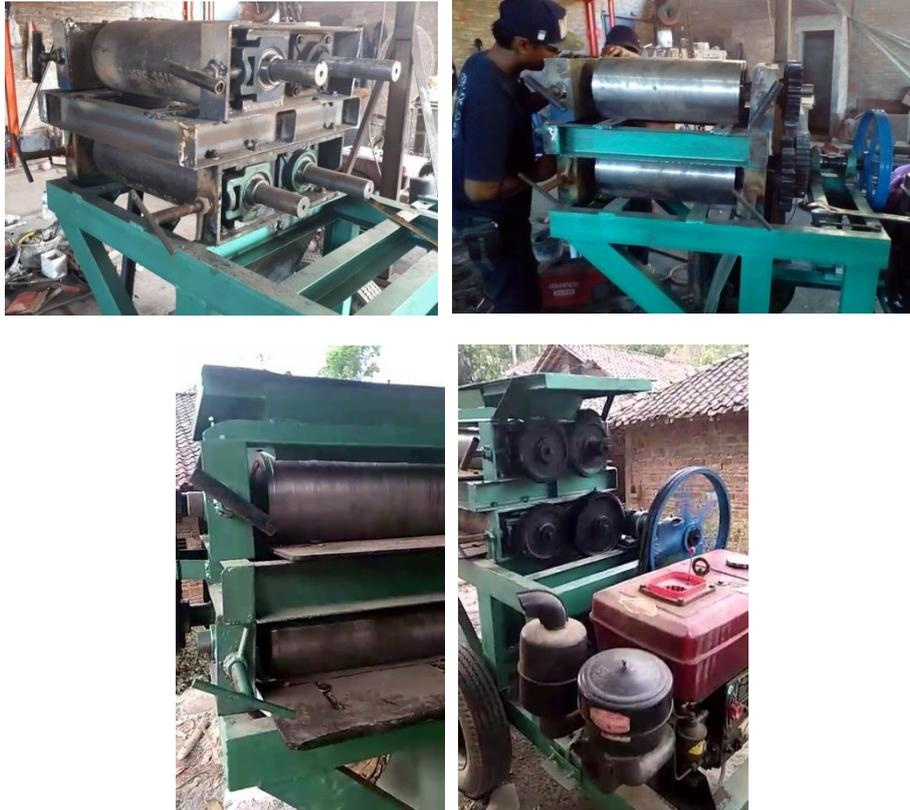
Gambar 6. Mesin penggiling tanah bertingkat.
