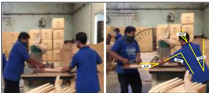
Gambar 4 Sebelum Usulan Perbaikan Stasiun Kerja Spindle
