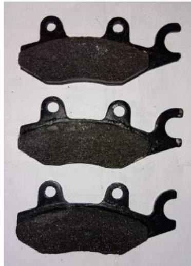
Gambar 2. Spesimen kampas rem variasi butiran mesh 50, 60, dan 100
