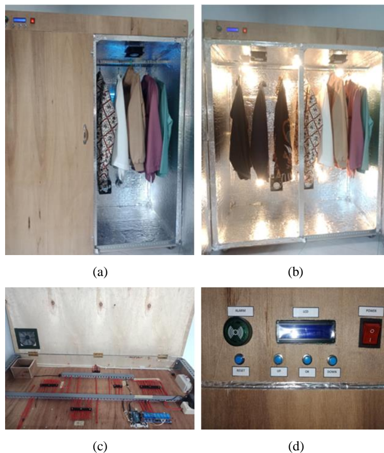
Gambar 4. Tampilan lemari pengering otomatis dengan fitur sterilisasi; tampilan depan lemari dengan satu pintu terbuka (a), tampilan dalam lemari saat beroperasi (b), rangkaian elektronik di lemari bagian atas (c), dan tampilan panel control di pintu lemari bagian kiri (d)
