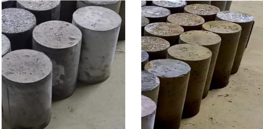
Gambar 3. Benda uji beton setelah direndam air (kiri) dan benda uji beton setelah direndam larutan klorida (kanan)
