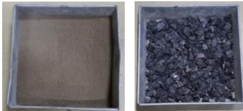
Gambar 1. Fly ash (kiri) dan steel slag ukuran 20mm (kanan)
