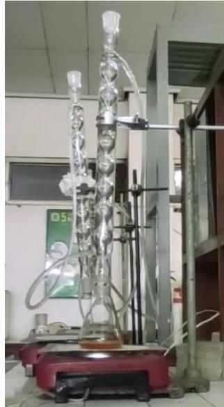
Gambar 2. Rangkaian Alat Refluks untuk Pengukuran COD
