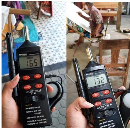
Gambar 1. Pengukuran dengan *Luxmeter*
