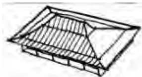
Gambar 3. Atap Limasan Jawa Tengah (sumber: Roesmanto, Totok: 2018)
