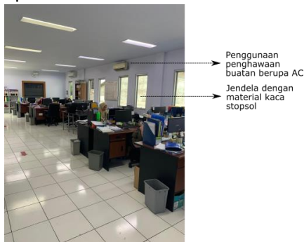
Gambar 9. Sistem Penghawaan Alami dan Buatan (Sumber: Penulis, 2022)
