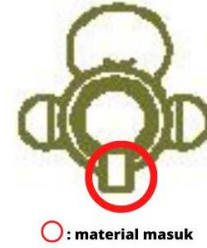
Gambar 6. Keluar masuk material pada mesin Roller
