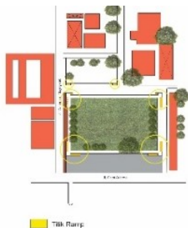
Gambar 8. Rencana perletakan titik ramp (sumber: Dokumen Pribadi, 2022)
