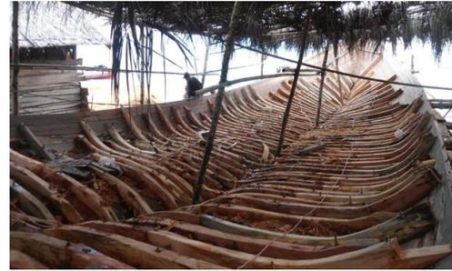
**Gambar 2. Kayu Bitti untuk konstruksi lambung kapal pinisi di Bulukumba**
