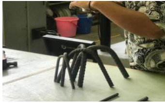
Gambar 3. Hasil Pengujian Kuat Leleh Baja Tulangan
