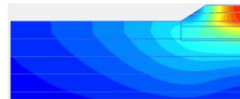
**Gambar 14. Displacement yang terjadi pada struktur perkuatan pada segmen 2**
