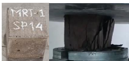
Gambar 6. Kubus mortar sebelum dan setelah pengujian tekan
