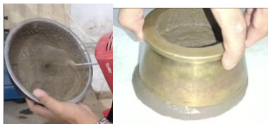
Gambar 4. Proses pencampuran dan pengujian mortar
