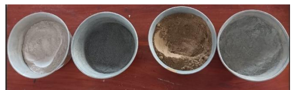
Gambar 3. Material penyusun mortar (superplasticizer, pasir, fly ash dan semen)
