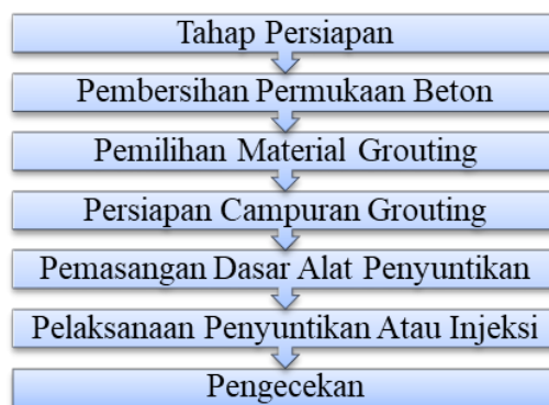
Gambar 3. Bagan alir urutan pekerjaan grouting kolom
