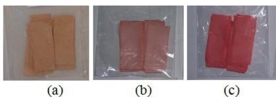
Gambar 3.2. Kertas indikator asam basa dengan pelarut (a) akuades (b) etanol 95% dan (c) etanol 95%+HCl 1%.
