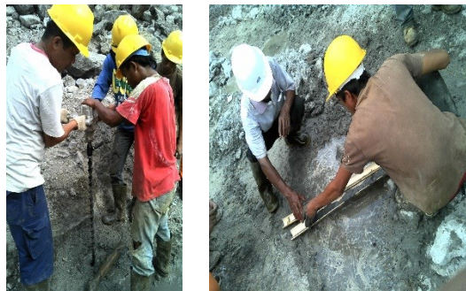
Gambar 10. Pengambilan sampel bor aspal
