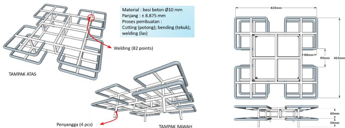
Gambar 2. Desain dan dimensi rangka besi bentuk puzzle sebagai katoda untuk sistem akresi mineral
