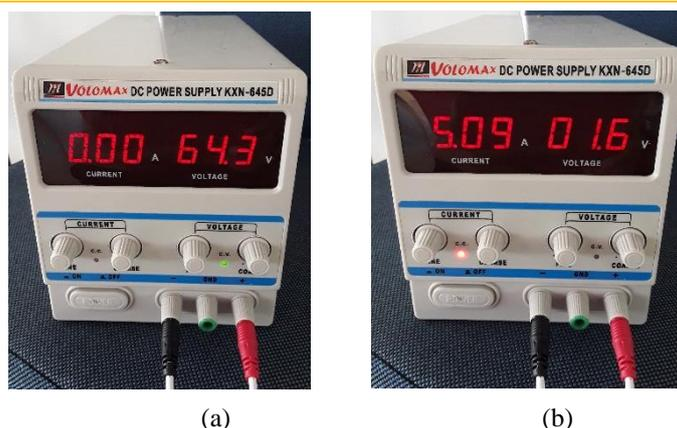
Gambar 5. Catu daya linier adjustable yang terdapat pembatas arus maksimum; (a) Tegangan listrik 0 – 65 Volt
