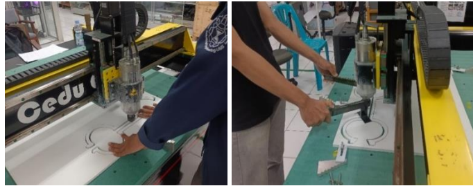
Gambar 9. Sebelum dan Sesudah Penggunaan Clamping Tambahan
