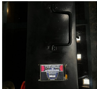
Gambar 10. Pemasangan LCD Nextion
