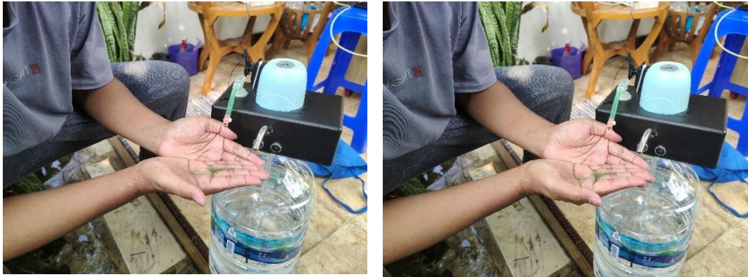
Gambar 9. Pengujian Sensor Ultrasonik HC-SR04 pada Sabun
