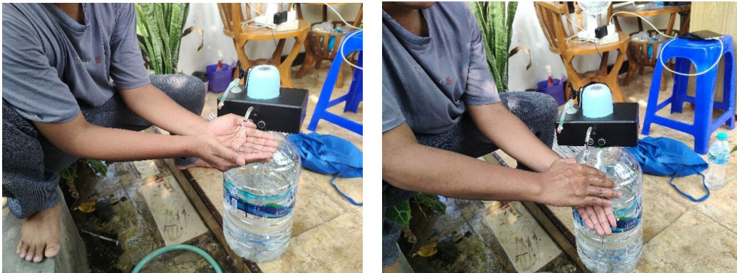
Gambar 8. Pengujian Sensor Ultrasonik HC-SR04 pada Pompa Air
