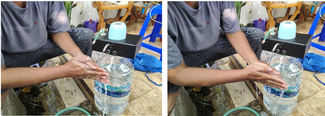
Gambar 10 Pengujian Sensor Ultrasonik HC-SR04 pada Pompa air (setelah sabun)
