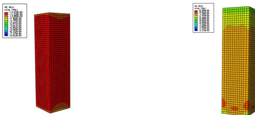
Gambar 3. Hasil regangan E11 dan E33 spesimen kolom akibat beban aksial
