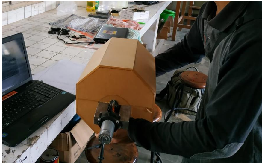
Gambar 9. Pengujian Pendulum X dan Z dengan eksitasi random
