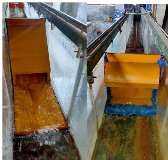
Gambar 3. Tampak belakang dan depan model sifon pelimpah
