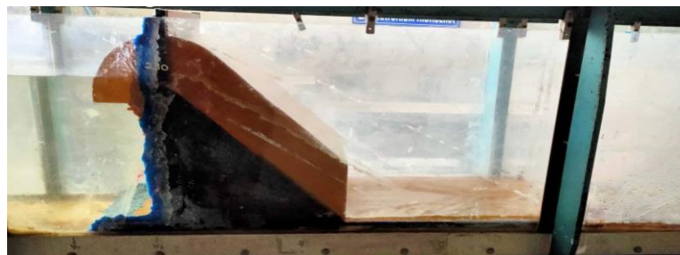
Gambar 2. Tampang memanjang model sifon pelimpah
