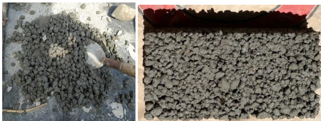
Gambar 1. Proses pembuatan benda uji (kiri) dan hasil proses pencetakan benda uji (kanan)
