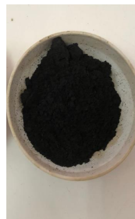
Gambar 3. Adsorben Serabut kelapa setelah dihaluskan
