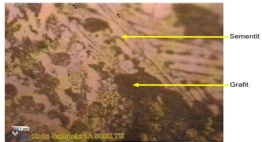
Gambar 5. Struktur mikro spesimen 1C (dilapisi karbon) bagian atas pembesaran 500x
