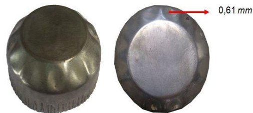
Gambar 10. Hasil Pengujian Cup Drawing Tanpa Sambungan
