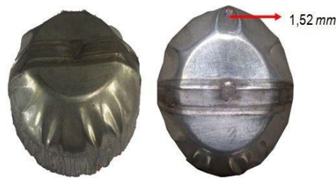
Gambar 9. Hasil Pengujian Cup Drawing Sambungan Las Titik
