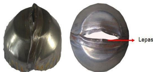
Gambar 11. Hasil Pengujian Cup Drawing Sambungan Tekuk
