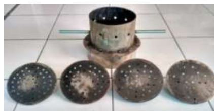
Gambar 2. Kubah burner dan tutup burner dengan variasi jumlah lubang 20, 30, 40, dan 50.
