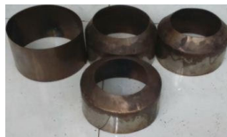
Gambar 3 Keterangan dari kiri reflektor bulat sudut 0°,30°,45°,60°
