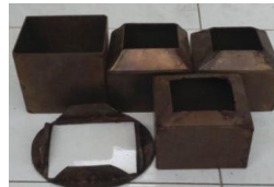
Gambar 4 Keterangan dari kiri reflektor segiempat sudut 0°,30°,45°,60°
