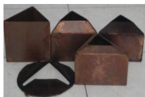
Gambar 4 Keterangan dari kiri reflektor segiempat sudut 0°,30°,45°,60°
