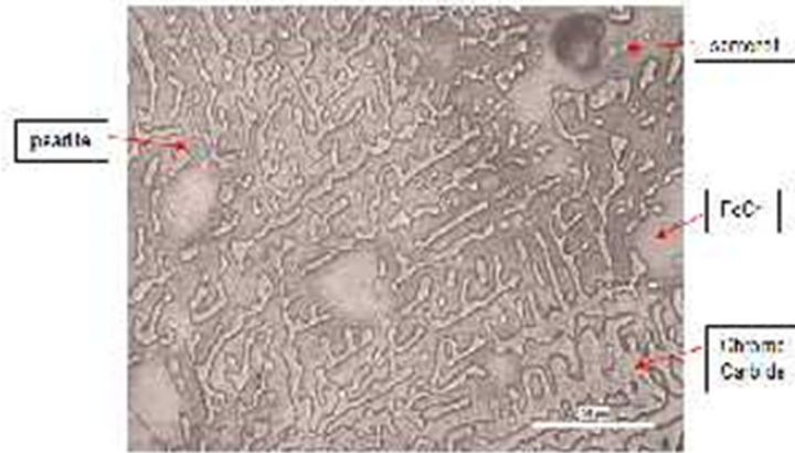
Gambar 12. Struktur Mikro Baja SKD 11 Tanpa Mengalami Perlakuan Panas Pembesaran 500x
