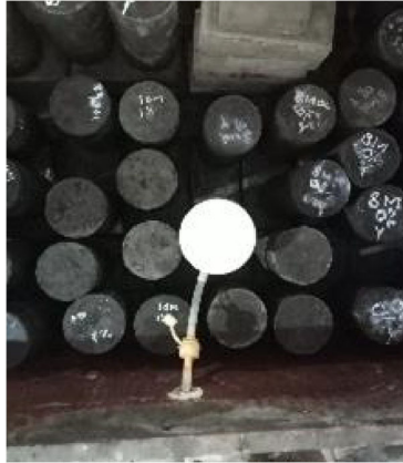
Gambar 3. Perawatan Beton Menggunakan Steam
