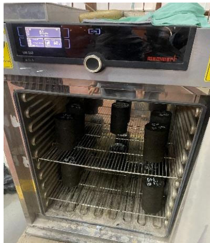
Gambar 2. Perawatan Beton Menggunakan Oven
