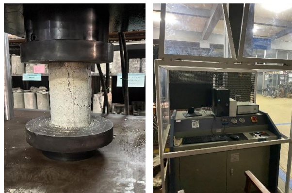
Gambar 1. Pengujian kuat tekan beton dengan UTM (kiri) dengan hasil pengujian pada komputer (kanan)
