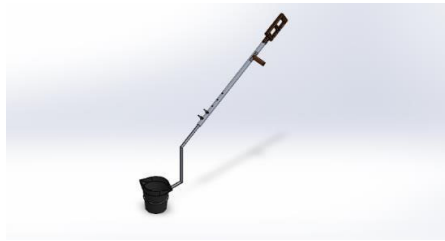
Gambar 2. Desain Ladle Pengecoran Logam
