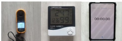
Gambar 3. Anemometer, Higrometer, dan Timer (Sumber: Dokumen Penulis, 2021)
