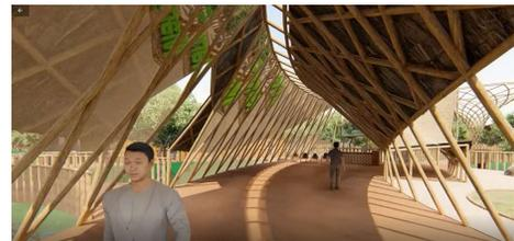
Gambar 19 Ekspose Struktur dan Material Bambu pada Lobby
