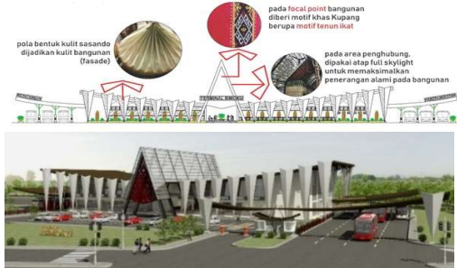
Gambar 5. Konsep fasad bangunan (Sumber : hasil rancangan, 2021)
