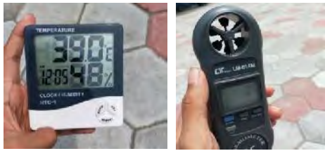
Gambar 5. Pengukuran Termal dan angin material paving (sumber: Dokumen Pribadi, 2019)
