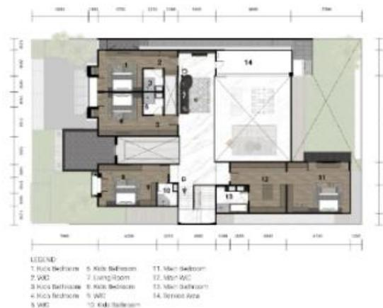
**Gambar 6. Denah Konseptual Perancangan R-House Lantai 2**
