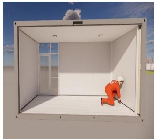
**Gambar 8. Aplikasi Joint Sealant pada Sambungan Dinding dan Lantai**
