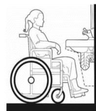
**Gambar 15. Perletakan Bak Cuci Tangan.**
