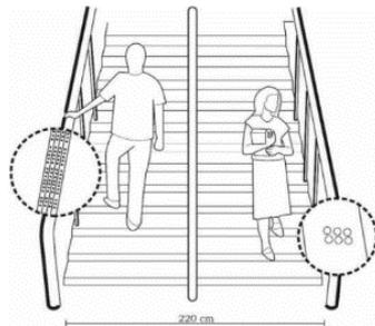
Gambar 4. Tangga Yang Dilengkapi Dengan Huruf Braille Di Sisi Atas Pegangan Rambatan. (Sumber: Permen PUPR No. 14 2017)
