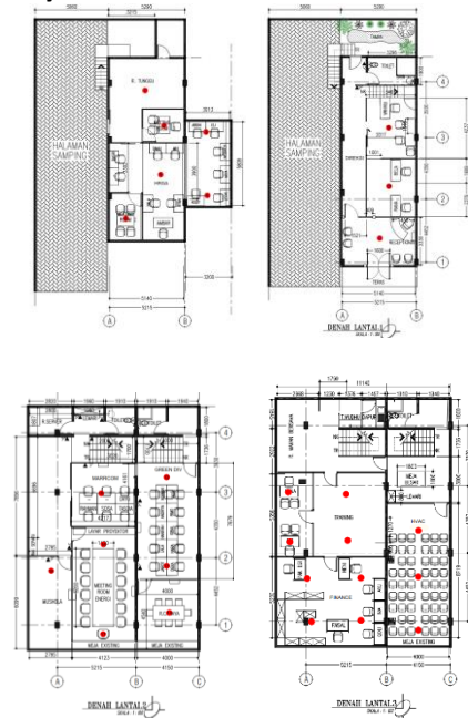
Gambar 3. Denah titik Pengukuran (Sumber : Dokumentasi Penulis)
