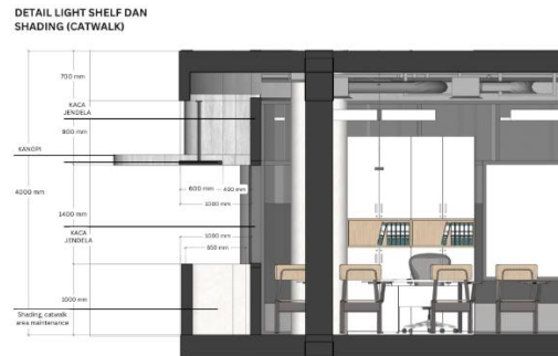
Gambar 11. Detail Bukaannya Balkon Bangunan Vokasi UB (Sumber: Dokumen Penulis, 2024)
