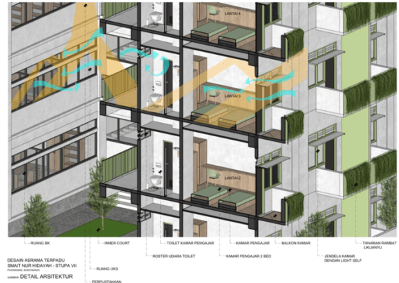
Gambar 13 Simulasi Pencahayaan dan Penghawaan pada Kamar Asrama SMA IT Nur Hidayah (Sumber: Dokumen Penulis, 2025)
