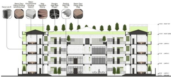
Gambar 14 Detail Penggunaan Material pada Asrama SMA IT Nur Hidayah (Sumber: Dokumen Penulis, 2025) Implikasi Praktis dan Rekomendasi
