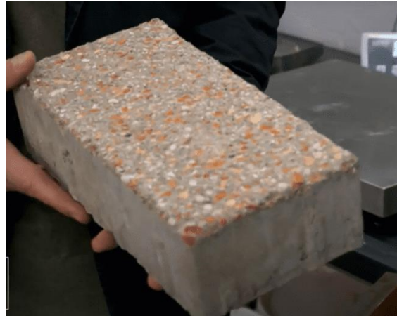
Gambar 3 Hasil Beton Daur Ulang dari Sisa Bangunan (Sumber: dw.com/indonesian ,2024)
