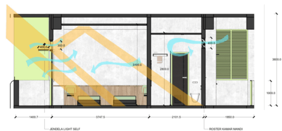
Gambar 14 Detail Light shelf dan bukaan Jendela pada Kamar Asrama SMA IT Nur Hidayah (Sumber: Dokumen Penulis, 2025)
